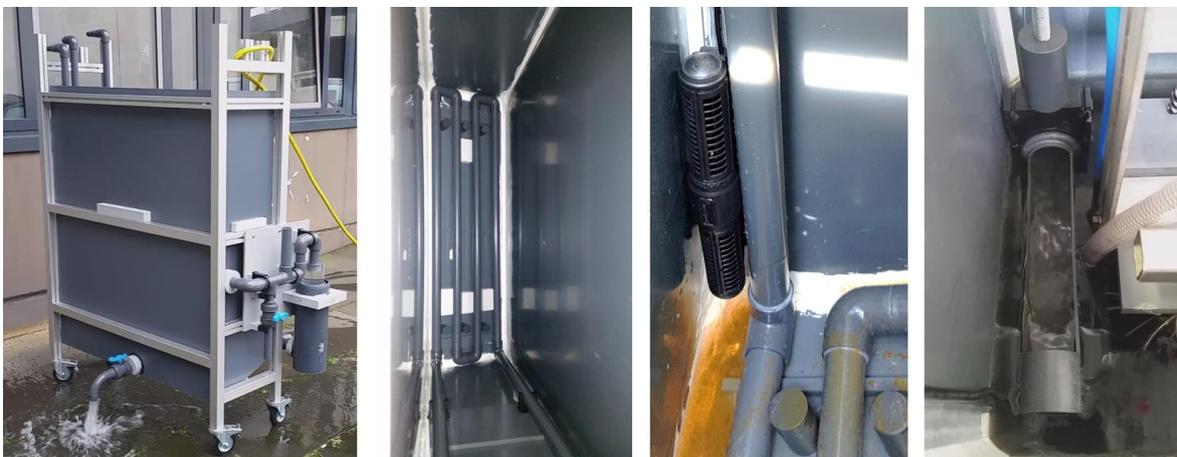
**Abbildung 8: Fotos des Reaktors (links), der Wärmeaustauscherschleife (2 v.l.), einer der installierten Strömungspumpen (3 v.l.) und der Überlaufrinne (rechts)**
