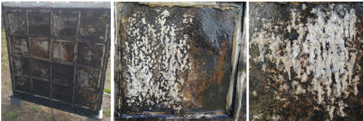
**Abbildung 33: Gesamtansicht (links) und Nahaufnahmen (Mitte und rechts) der Ablagerungen auf den Kathoden**
