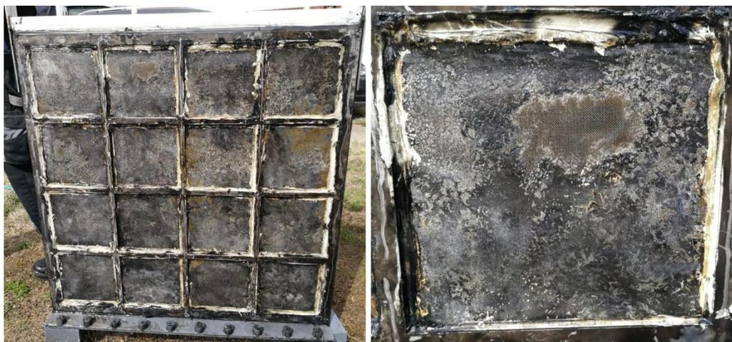
**Abbildung 34: Gesamtansicht (links) und Nahaufnahme (rechts) der mechanisch gereinigten Kathode**
