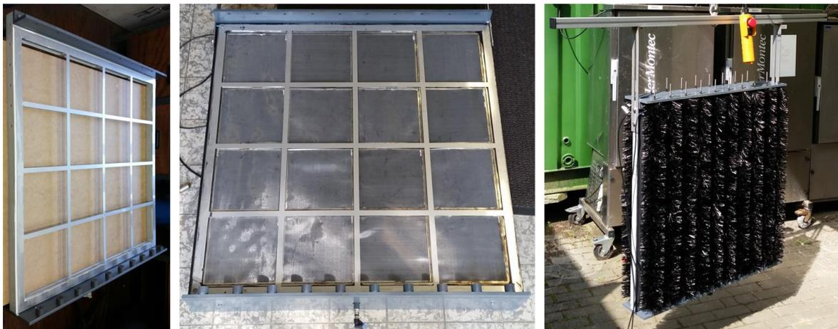
**Abbildung 7: Fotos des Elektrodenmoduls. Links: ohne Kathoden und Anoden. Mitte: mit montierter Kathode. Rechts: komplett montiert mit Kathoden und Anoden**
