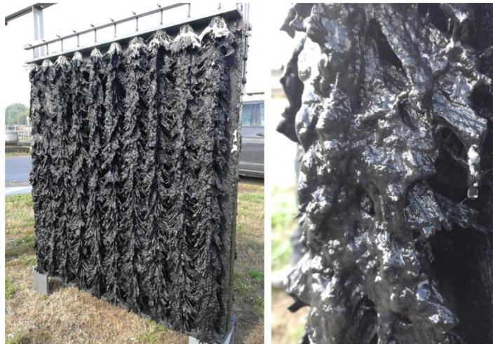
**Abbildung 32: Ausgebautes Elektrodenmodul mit montierten, bewachsenen Anoden (links) und Nahaufnahme des Biofilms auf den Anoden (rechts)**
