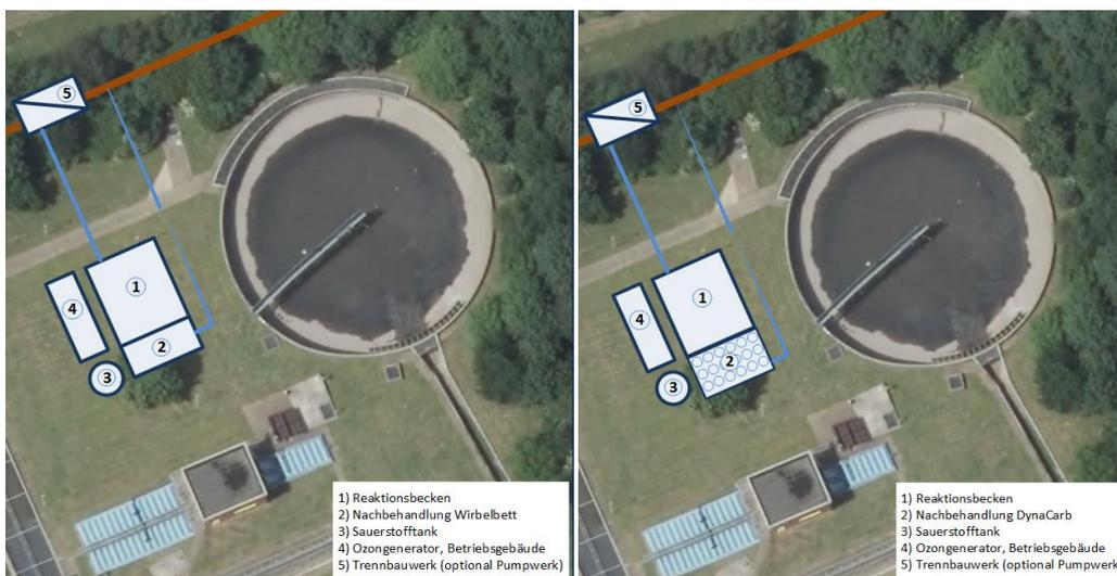
**Abbildung 4-4: Lageplan der Variante 1a (links) und 1b (rechts)**
