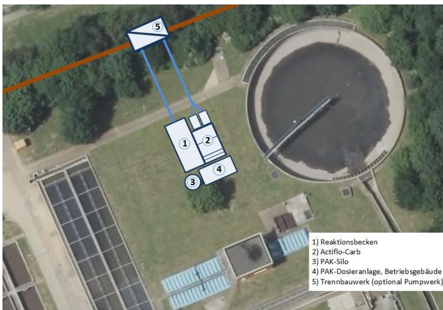
**Abbildung 4-5: Lageplan der Variante 2, PAK-Anlage auf Freifläche**
